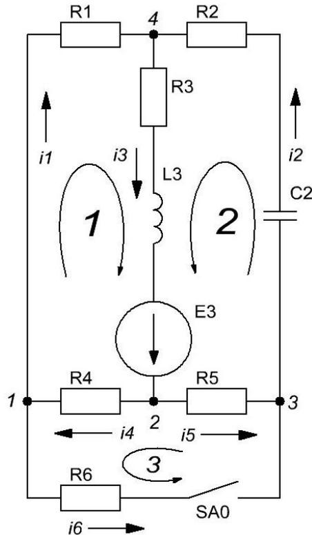
Рисунок 1. Расчетная электрическая схема цепи для определения переходного процесса тока  $i_3$  при замыкании ключа SA0.
