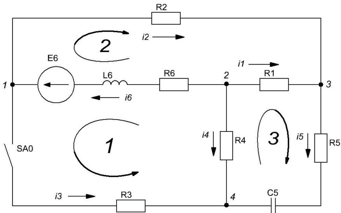
Рисунок 1. Расчетная электрическая схема цепи для определения переходного процесса тока  $i_6$  при замыкании ключа SA0.
