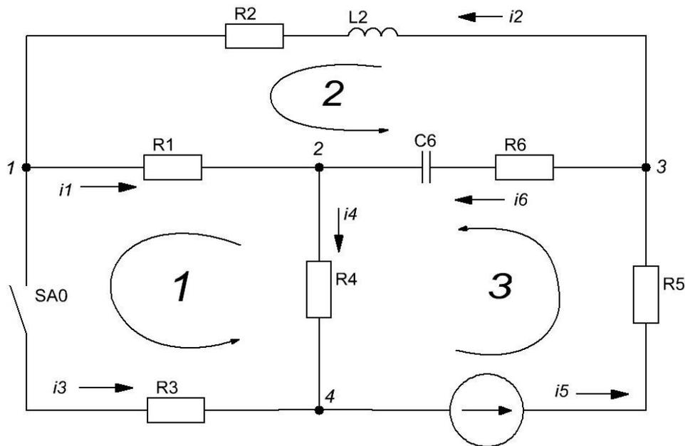
Рисунок 1. Расчетная электрическая схема цепи для определения переходного процесса тока  $i_2$  при замыкании ключа SA0.
