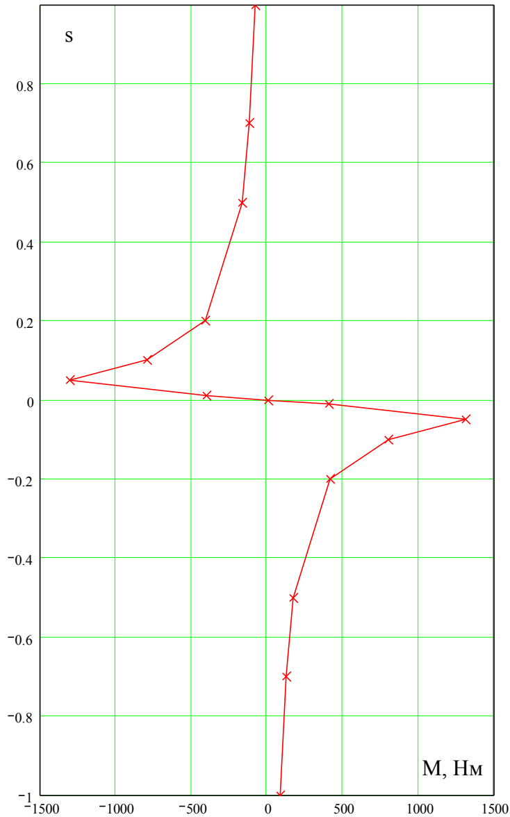
Рисунок 13. Механічна характеристика двигуна в режимі динамічного гальмування
